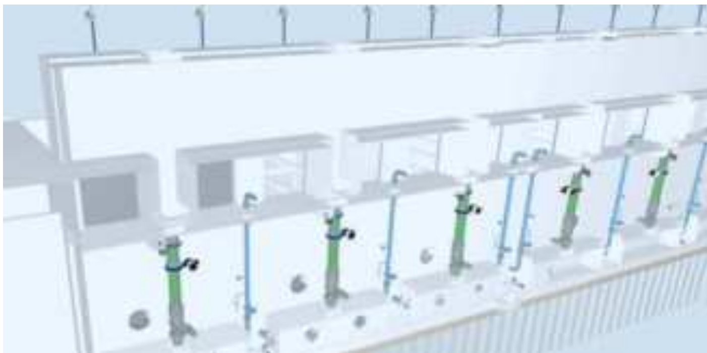
Figure 3-13 : vue des cheminées et des conduites d'alimentation des cellules de Biostyr®
