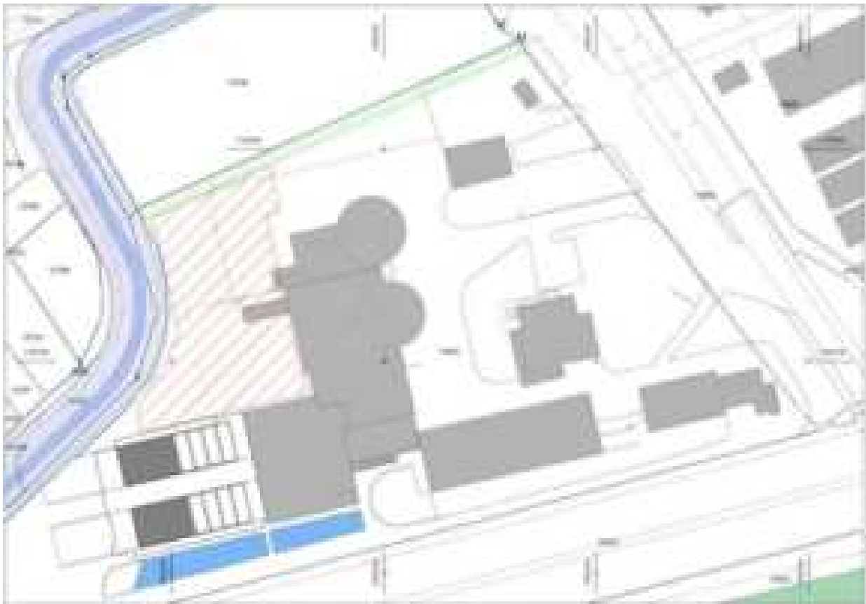
Figure 2-8 : Espace réservé aux eaux (en bleu) (tracé pas encore validé), distance limite au parcellaire (en vert) et emplacement disponible sur la parcelle de la STEP pour l'extension de la biologie (en rouge).
