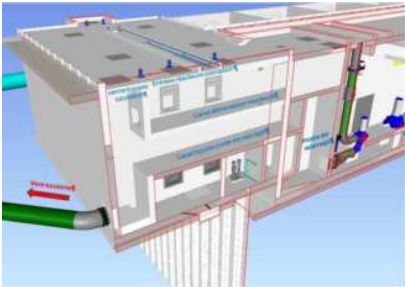
Figure 4-2 : vue du canal d'alimentation et du bypass des réacteurs d'ozonation
