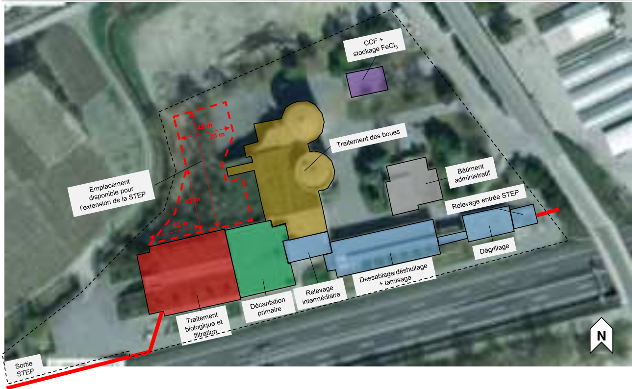
Figure 2-3 Schéma d'emplacement des bâtiments actuels et de la place disponible pour l'extension de la STEP
