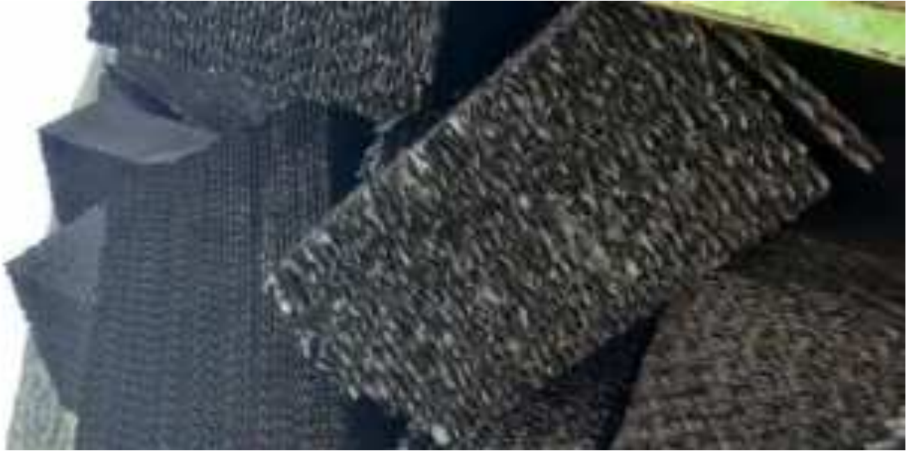
Figure 3-5 Photo de garnissage structuré
