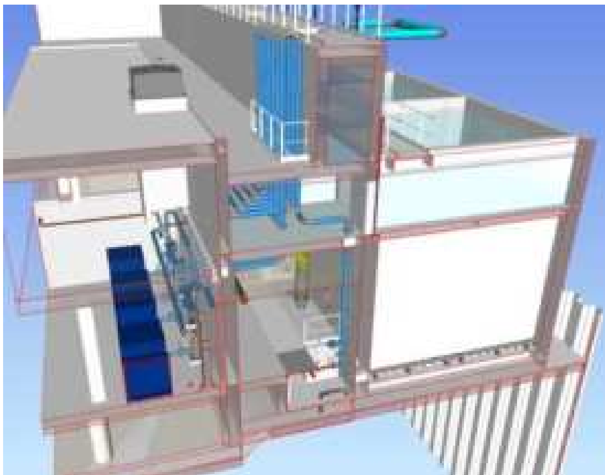
Figure 3-16 : Vue des conduites d'alimentation en air des Biostyr® DUO N
