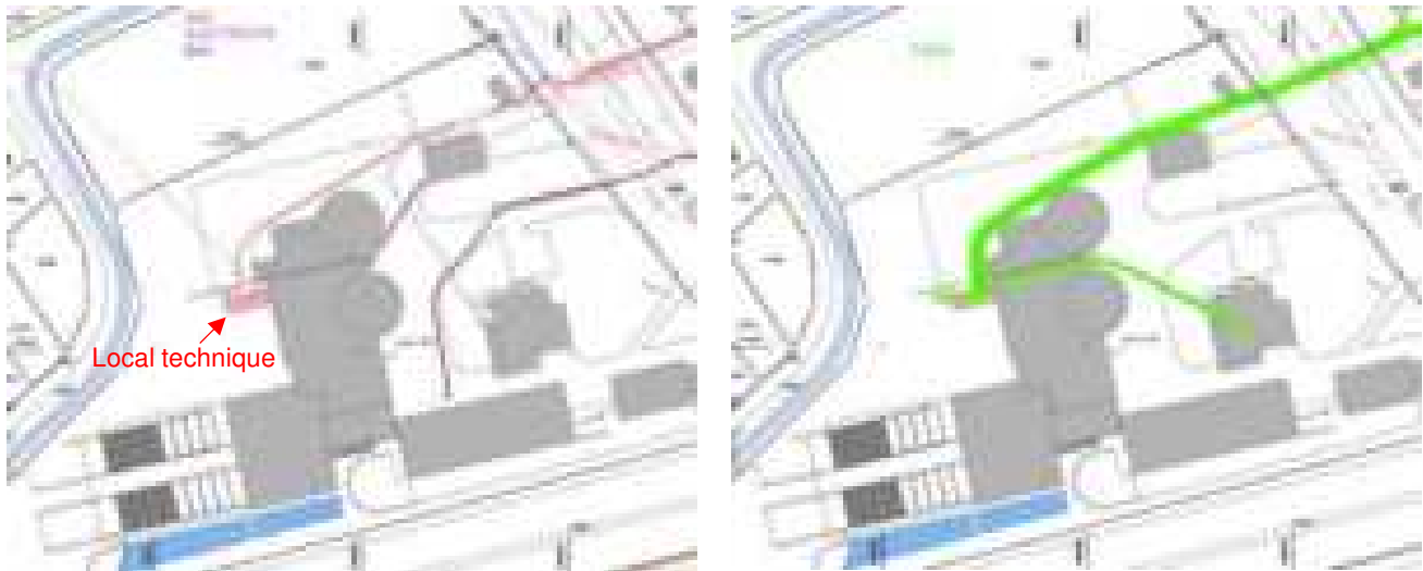
Figure 2-6 Réseaux existants sur le site de la STEP de Noës. Gauche : réseaux de gaz, électricité et eau. Droite : réseau de fibre optique. Source : Oïken
